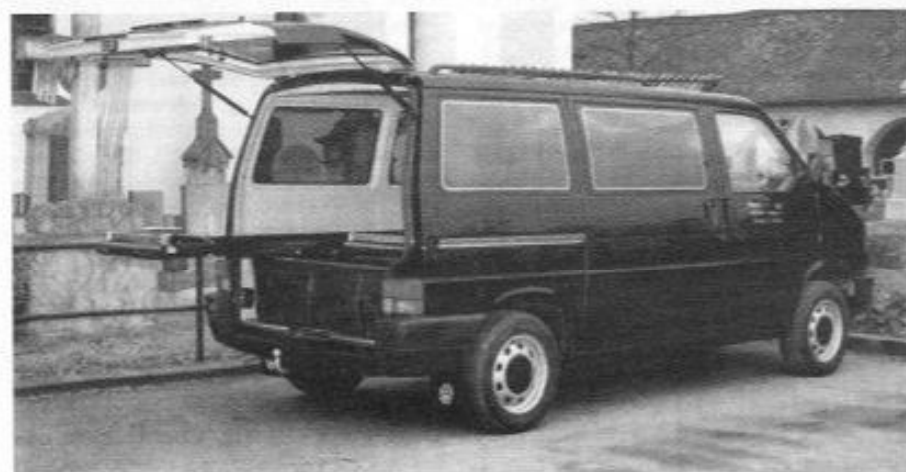
Tak wygląda przedział ładunkowy standardowego pojazdu ceremonialnego VW T4. Dzięki podwyższonej podłodze, znajdującej się ponad wnękami kół, możliwy jest przewóz dwóch trumien.
